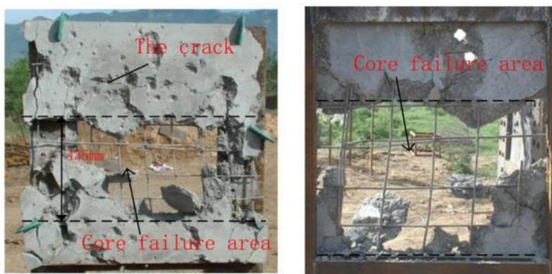
מבט לפנים ולאחור של מטרת הבטון לאחר הניסוי (Li et al. 2020)
