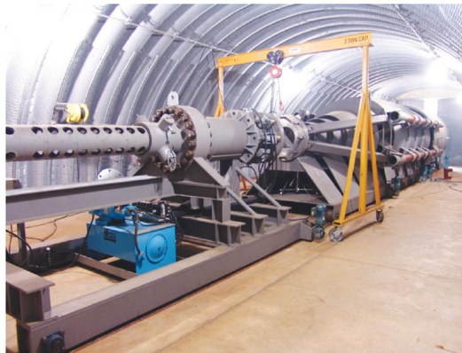
סימולאטור מדמה עומס פיצוץ של מכון המחקר הנדסי של הצבא האמריקאי (ERDC)
